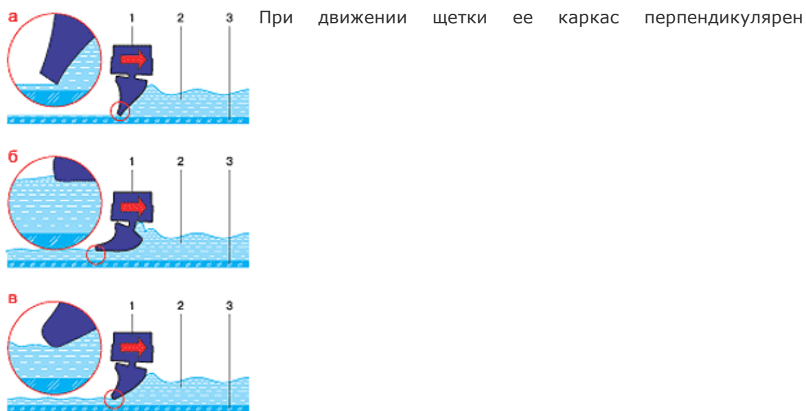
Рис. 3. Работа щетки стеклоочистителя: а — нормальная; б — чрезмерный наклон рабочей части ленты; в — изношенная рабочая кромка;
